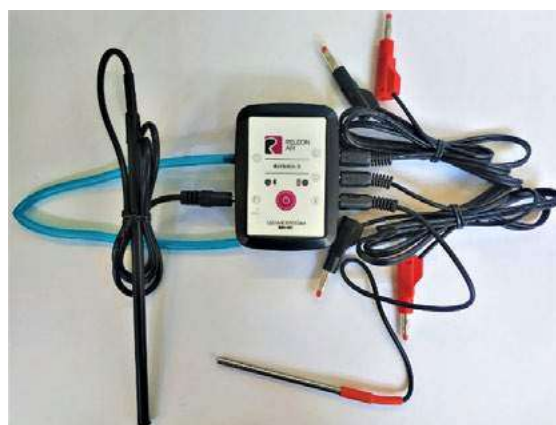
Рис. 9. Беспроводной мультидатчик Releon Air «Физика-5»
